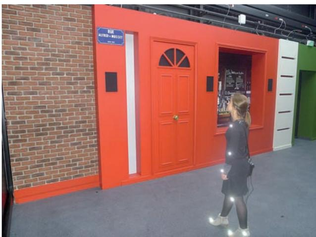
**Fig. 7-6** Capteurs Vicon® disposés sur le corps d'un volontaire.
