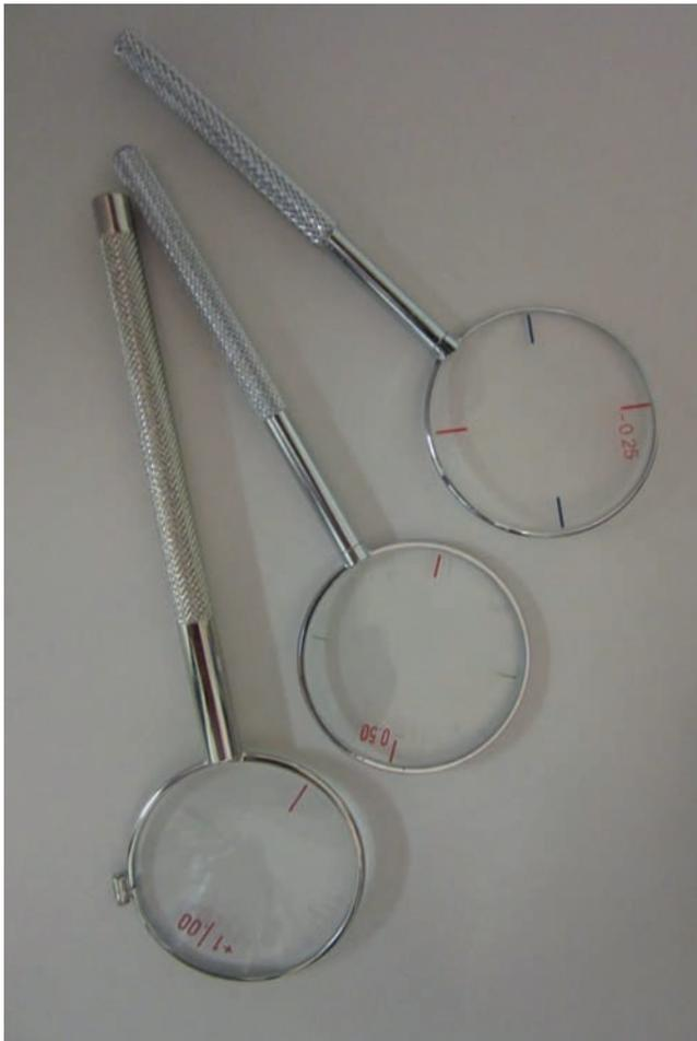
**Fig. 5-4** Cylindres croisés de  $\pm 0,25$ ,  $\pm 0,50$  et  $\pm 1,00$  à utiliser en fonction de la profondeur d'atteinte visuelle.
