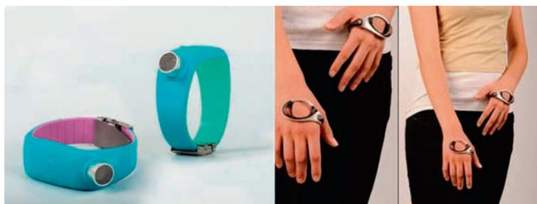
**Fig. 10-20** Bracelet connecté pour assister les déficients visuels pendant les déplacements en leur facilitant le repérage des obstacles à l'aide d'un système de sonar.
