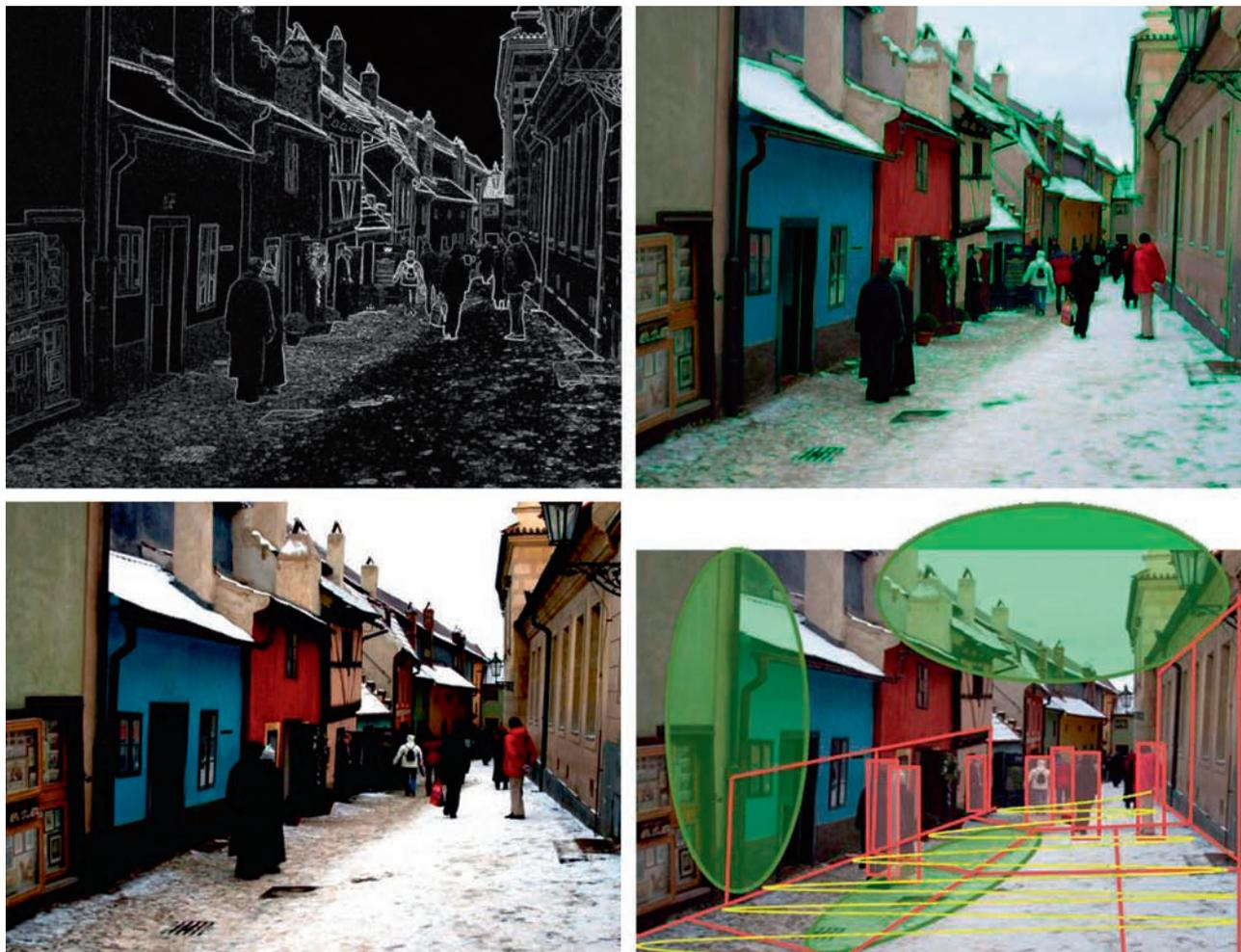
**Fig. 10-17** Exemple d'application de traitements d'images sur une scène visuelle par un renforcement des contours et des contrastes ainsi qu'une segmentation automatique des obstacles, des personnes mobiles et des éléments de direction de la rue. (Reproduction autorisée.)
