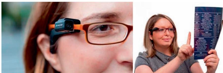
**Fig. 10-19** Système OrCam MyEye composé d'une caméra intégrée sur la branche de lunette couplée avec un système de reconnaissance d'images qui permet de lire le texte ou l'image pointé par le patient.
