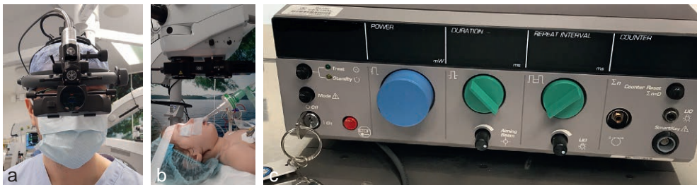
Fig. 15-49 a. Adaptateur laser pour ophtalmo­scope indirect. b. Adaptateur pour microscope opératoire. c. source laser diode.
